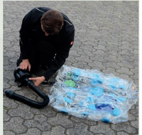
Das Gebläse in die BB einstecken und dabei dieses sowie den Luftschlauch so ausrichten, dass eine maximale Luftzufuhr gewährleistet ist.
