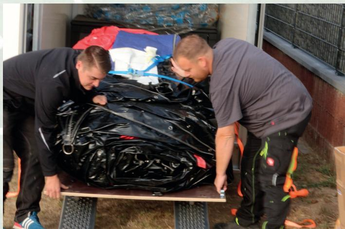
Den Spanngurt lösen, die BBA vom Transportwagen herunterheben und entrollen.
